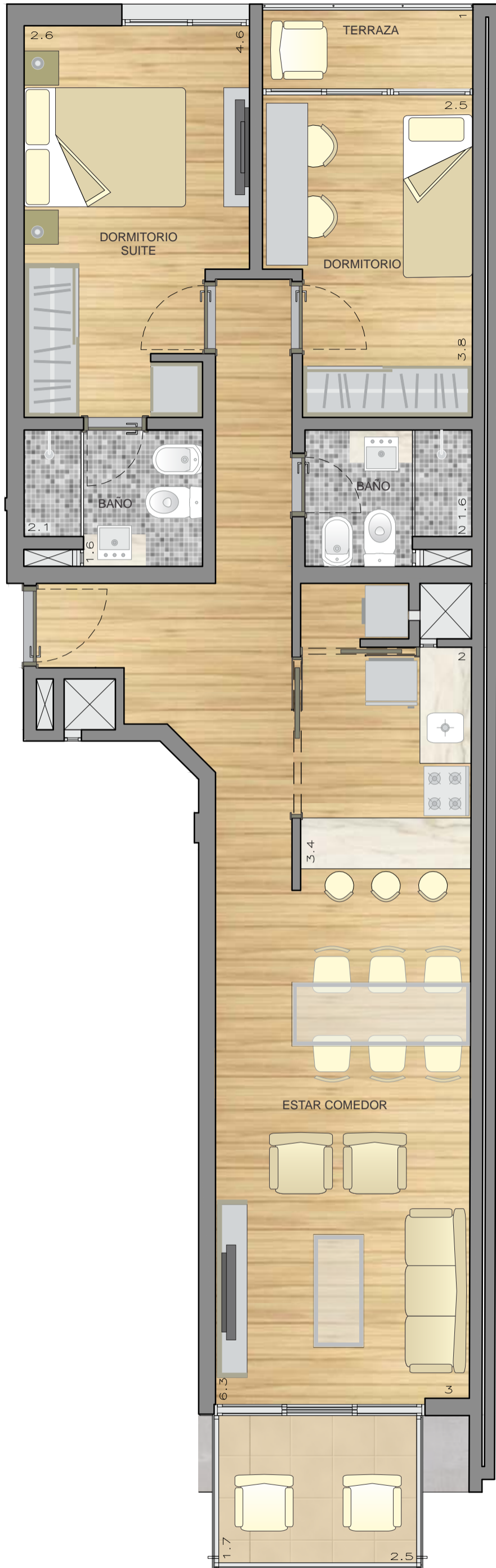
PLANTA TIPO UNIDAD 02 [ÁREA 83m 2 ] ESC. 1.50
